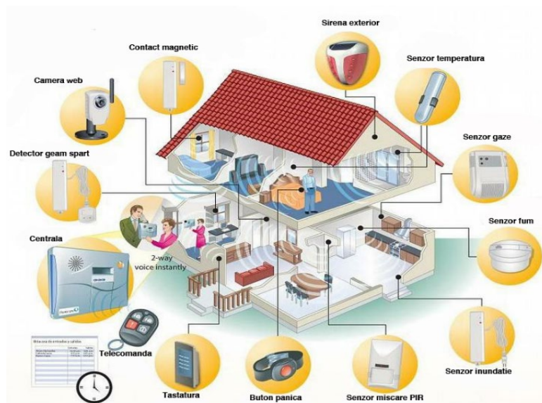
Fig. 2 Sistem de alarmă
